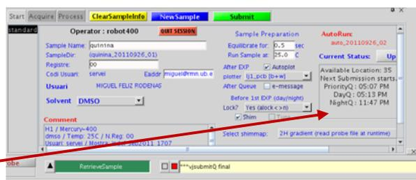
Situar el tubo-spinner en la posición del cambiador que nos indica el equipo
